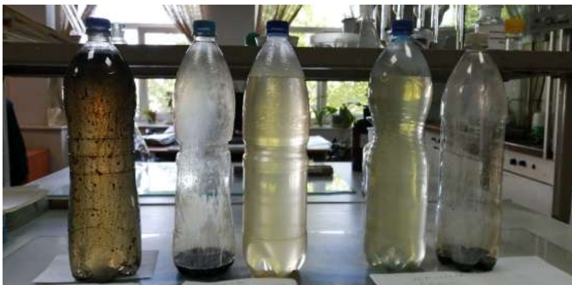
Рис. Результаты эксперимента. Левая проба- исходная жидкость, следующие- очищенные вода и нефтепродукты при различных режимах
