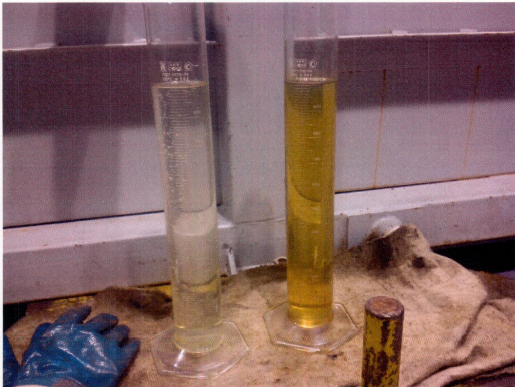
Рис.3 Результат отбора проб при обводненности рабочей жидкости 8%
