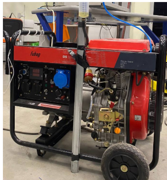
Макет дизель-генераторной установки с переменной частотой вращения
