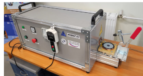
Образец установки «Илмаг-01» с оснасткой для упрочнения дисковых ножей
