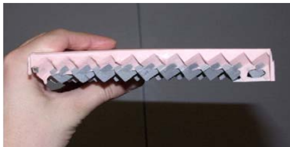
Рис.4. Гибридная структура из топологически самозацепленных металлических кубов с гибкой полимерной подложкой [9]
