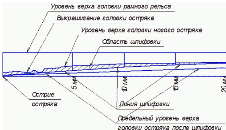
Рис. 6. Отметки максимального понижения остряка относительно рамного рельса в острие остряка и проектных сечениях головки 5, 10, 15, 20 мм.
