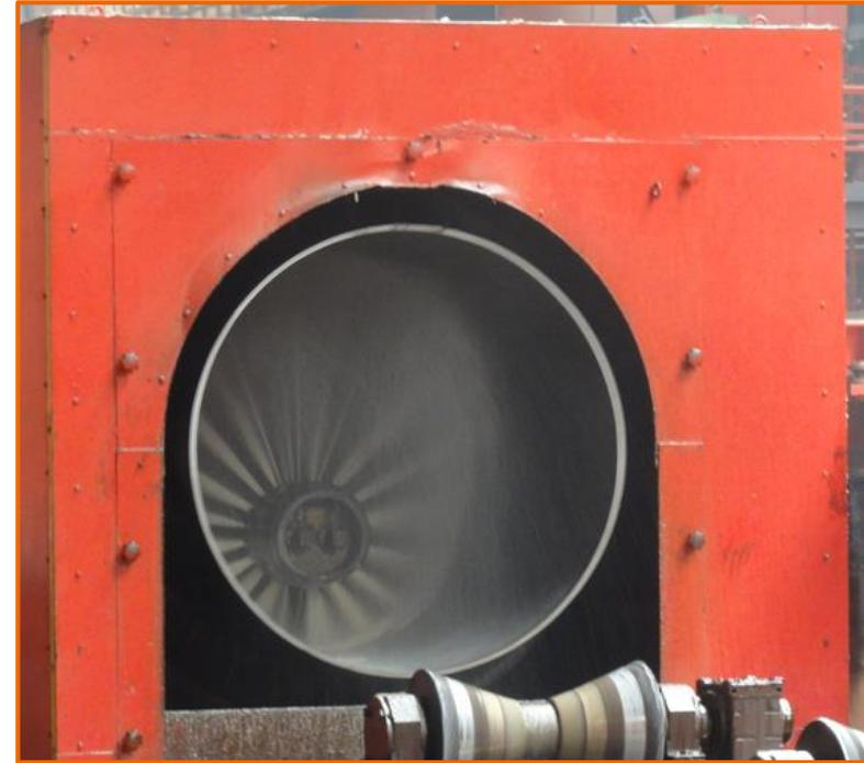
Рисунок 13 – Промывка трубной заготовки после экспандирования
