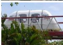
**Рио-Де-Жанейро, Бразилия** – первая низкоскоростная пассажирская система на постоянных и ВТСП магнитах, планируется расширение линии для охвата мегаполиса
