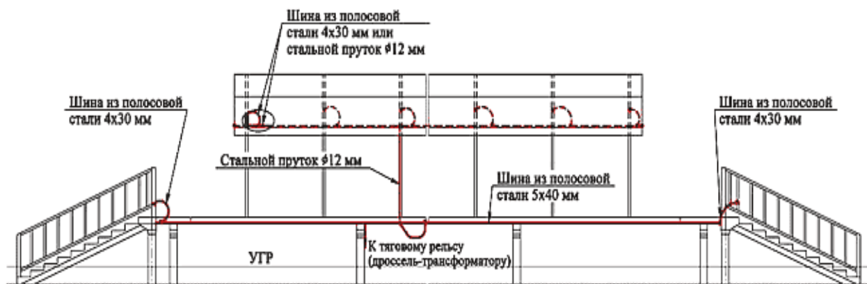
Рисунок 3.1.11.1.14. Заземление островной посадочной платформы (главный вид).
