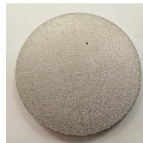
Порошок ТПП-8 Ø35 мм \rho=4,1 \text{ г/см}^3
