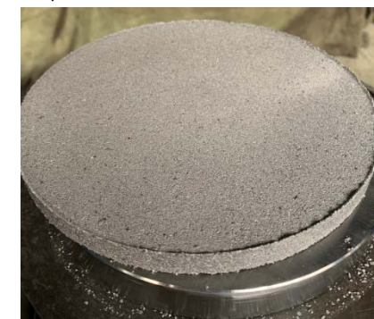
Порошок ТПП-6 Ø200 мм \rho=2,55 \text{ г/см}^3
