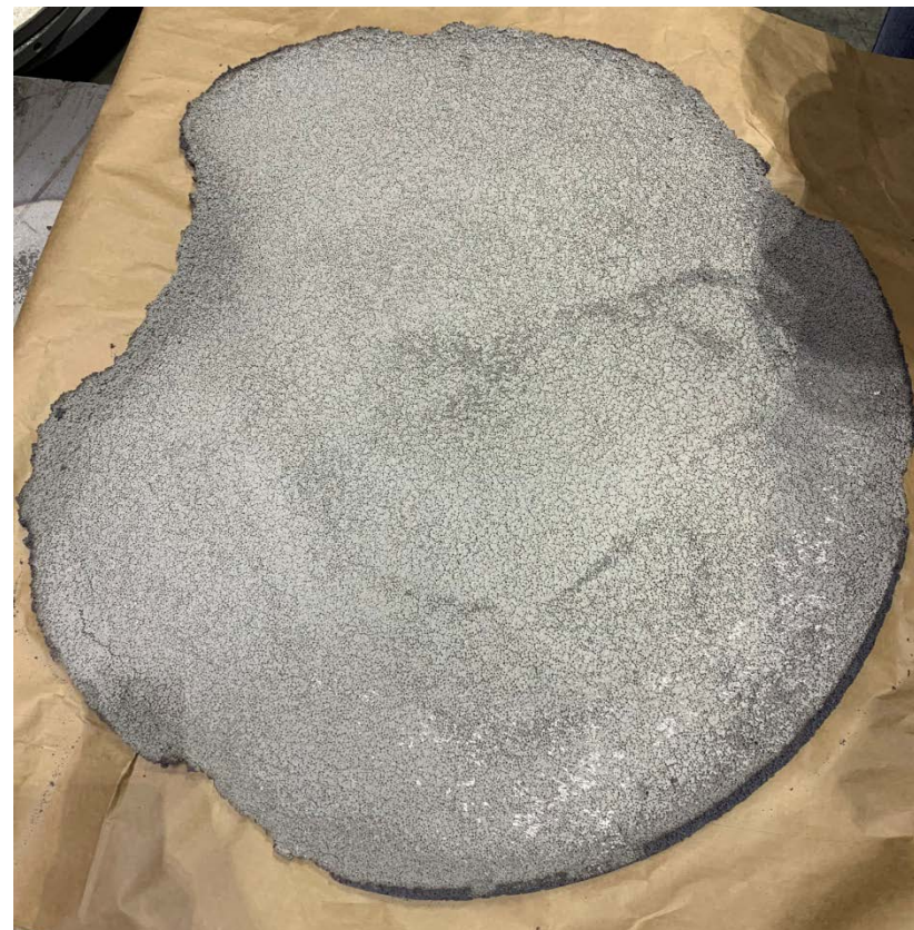
Ø 850 x 22 мм Порошок ТПП-7+карбамид Плотность 1,3 г/см 3
