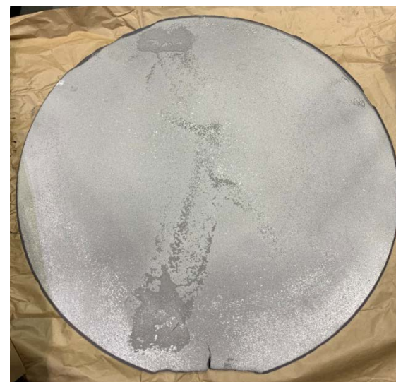
Порошок ТПП-7 Ø850 мм \rho=2,55 \text{ г/см}^3
