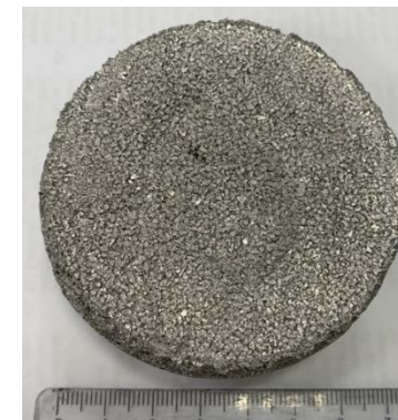
Порошок ТПП-4 Ø75 мм \rho=3,5 \text{ г/см}^3
