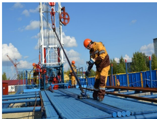
рис.6 Укладка ГНО на стеллажи(мостки)
