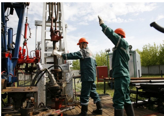
Рис.5 Начало подъема ГНО из скважины
