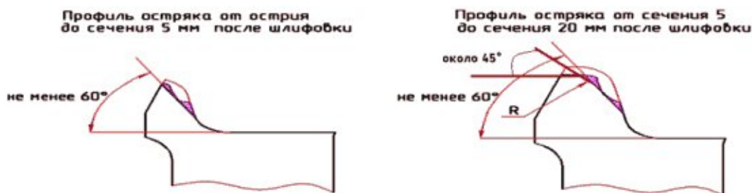
Рис. 5 Форма головки остряка после его шлифовки
