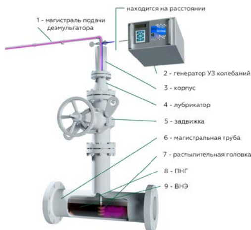
Рисунок 8—Структурная схема установки ультразвукового диспергатора
