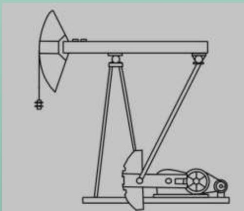
Привод СШН предназначен для приведения колонны насосных штанг в возвратно-поступательное движение.
