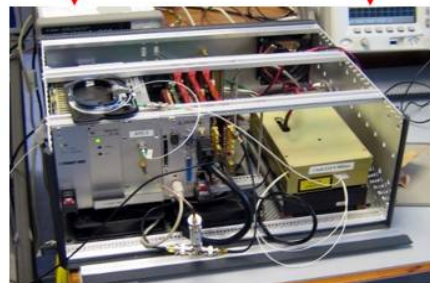
Оптоэлектронный блок опроса волоконной трассы
