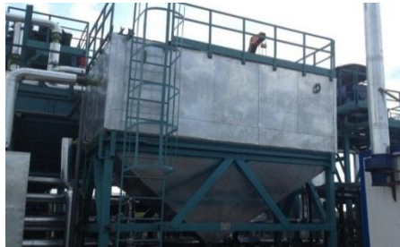
ГДС-50, работает в составе комплекса по утилизации нефтешламов, Лисичанском НПЗ
