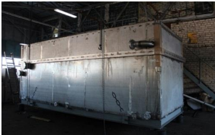
ГДС-60, Работает в составе государственного эталона учета массового расхода сырой нефти, АО «Нефтеавтоматика», Башкортостан
